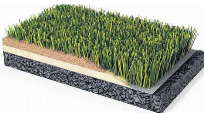
Systemaufbau des Kunstrasensystems „LigaTurf Ultimate CoolPlus“ von Polytan. Fotos: Polytan
