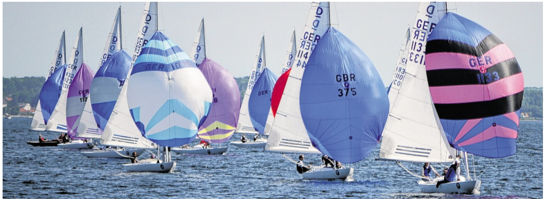
Drachen auf Vorwindkurs: Das ausgebaute Großsegel und der 24 qm große Spinnaker sorgen für Vortrieb.
