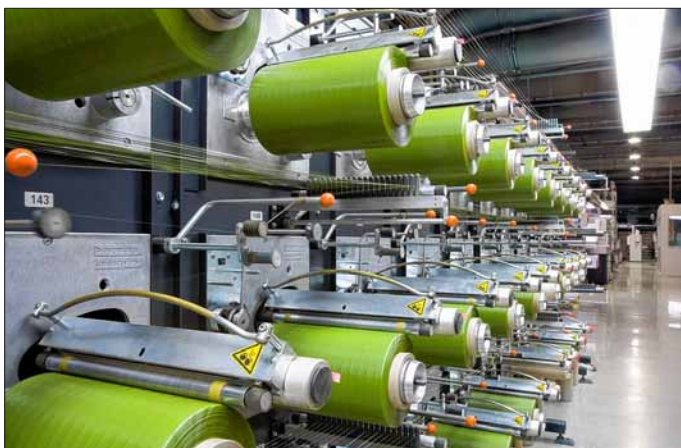
Das Garn wird über einzelne Spulen zur Tuftingmaschine geführt.
